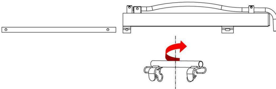
4/ remettre en place le tube de rotation en s'assurant que les 2 taquets de verrouillage sont bien en place :
