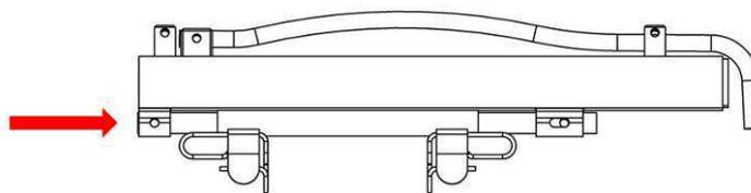
Le montage de la dérive se fait en insérant les taquets de positionnement dans les inserts situés sur les côtés de la coque arrière du brancard.
