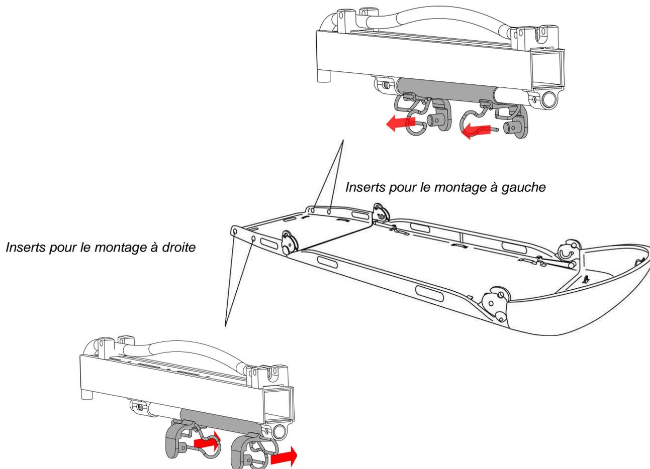
Pour le montage, le système d'attache doit être orienté dans le bon sens, goupilles de verrouillage à l'intérieur du brancard.
